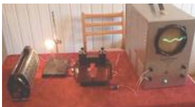
Наявність полів розсіювання при роботі навантаженого трансформатора
