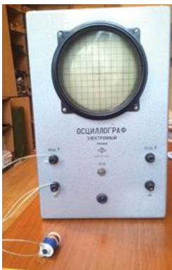
Давач магнітного поля під'єднаний до електронного осцилографа
